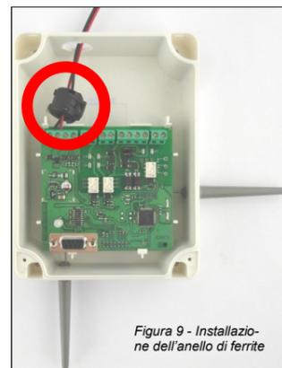
Figura 9 - Installazione dell'anello di ferrite
