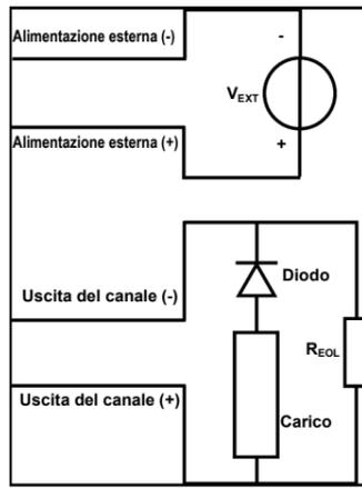
Figura 12 - cablaggio del canale supervisionato di uscita
