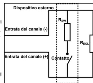
Figura 11 - cablaggio del canale di ingresso supervisionato
