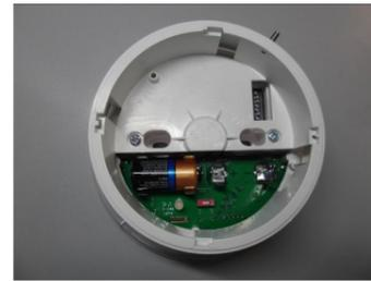
Figura 5 - batteria secondaria inserita
