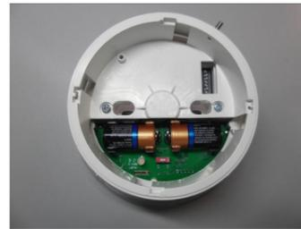
Figura 6 - batterie primarie e secondarie inserite
